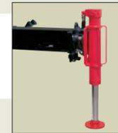
6段ブーム機は、回転格納式リヤアウトリガを標準装備。(最大張出し幅:2,500mm)
